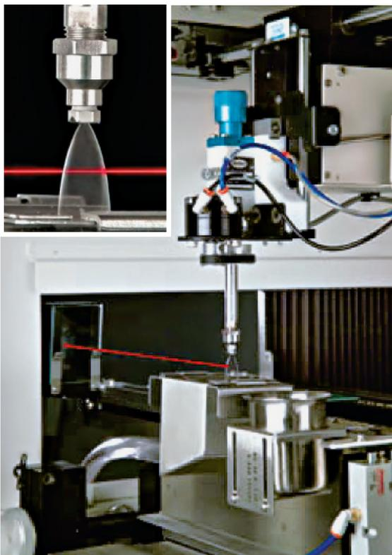
Рис. 5 Контроль ширины струи с помощью лазерного луча
